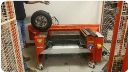
Essai de compactage d'enrobés
