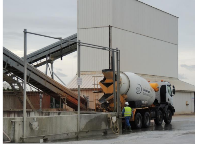
Nettoyage d'un camion malaxeur et récupération des eaux de lavage
